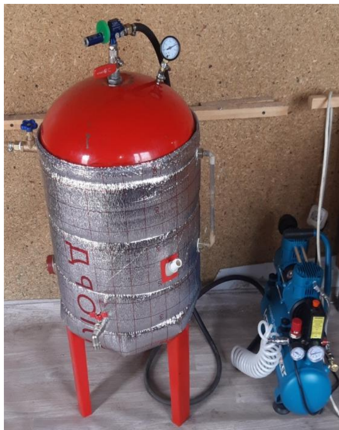
Рисунок 20 - Двухкамерный утилизатор рассолов
