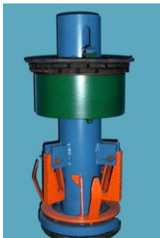
Рисунок 12 - Устройство для откачки воды по обсадной колонне скважины
