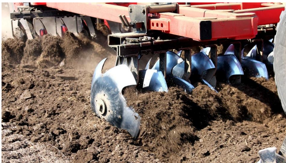
Рисунок 2 - Обработка почвы тяжелой дисковой бороной
