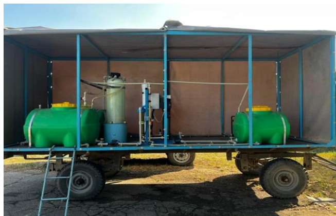
Рисунок 15 – Общий вид установки в транспортном положении
