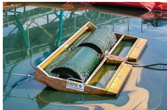
4-сурет. Скиммер арқылы мұнайды жинау технологиясы
