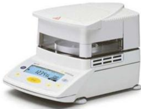
Сурет 1 – Термогравиметриялық ылғал өлшегіш инфрақызыл Sartorius MA-150
