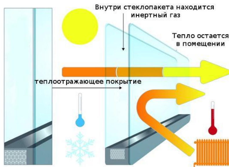
Рисунок 4 – устройство энергосберегающих стеклопакетов
