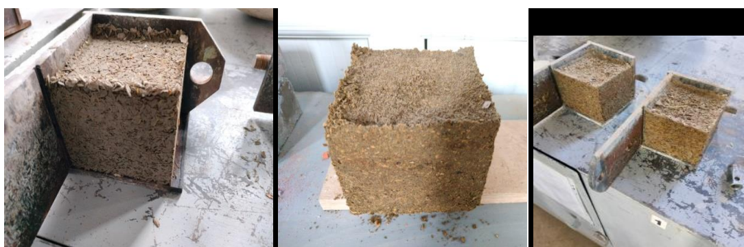
Сурет 3 - Сынамалауға дайындалған арболит үлгілері: а) ағаш жоңқалары негізінде; б) ағаш ұнтағымен, в) күріш сабанымен
