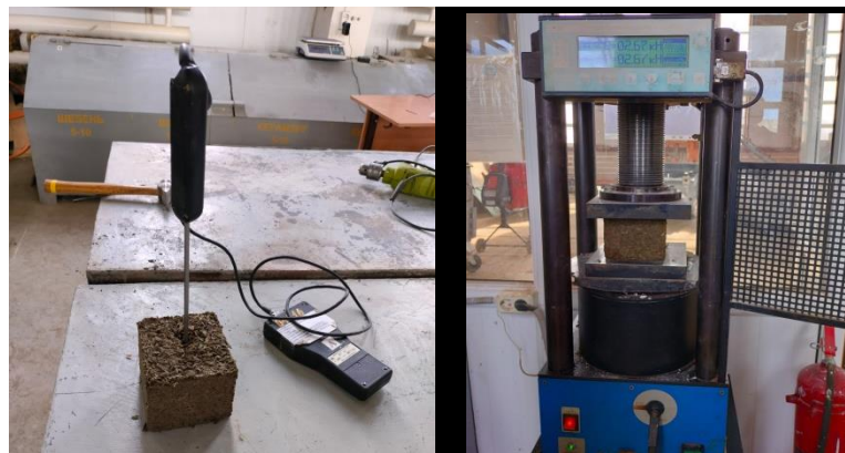
Сурет 4 - Материалдың жылу өткізгіштік пен сығуға беріктік қасиетін анықтау
