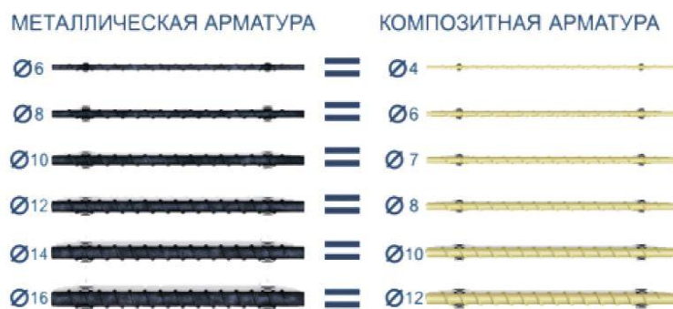
Рис. 3. Разница диаметров композитной и металлической арматуры
